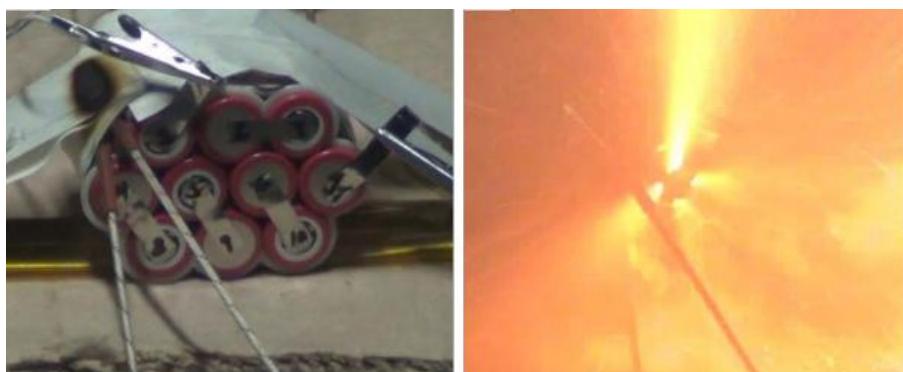
图 C.3 热电偶对电芯热失控时的燃烧火焰进行热点捕捉
